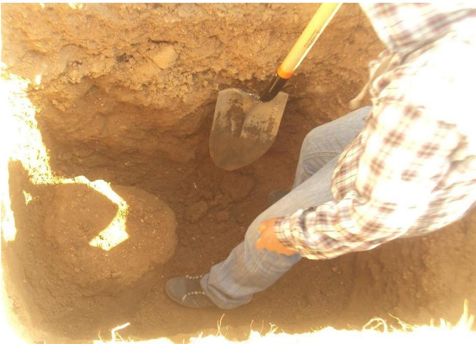
Imagen N° 08: Preparando la muestra para ser sacada de la calicata.
