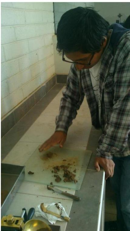
Imagen N° 22: Realizando el ensayo de límite plástico. (Limite plástico).
