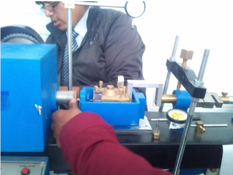
Imagen N° 28: Colocando la muestra en el equipo de corte directo. (Corte directo)
