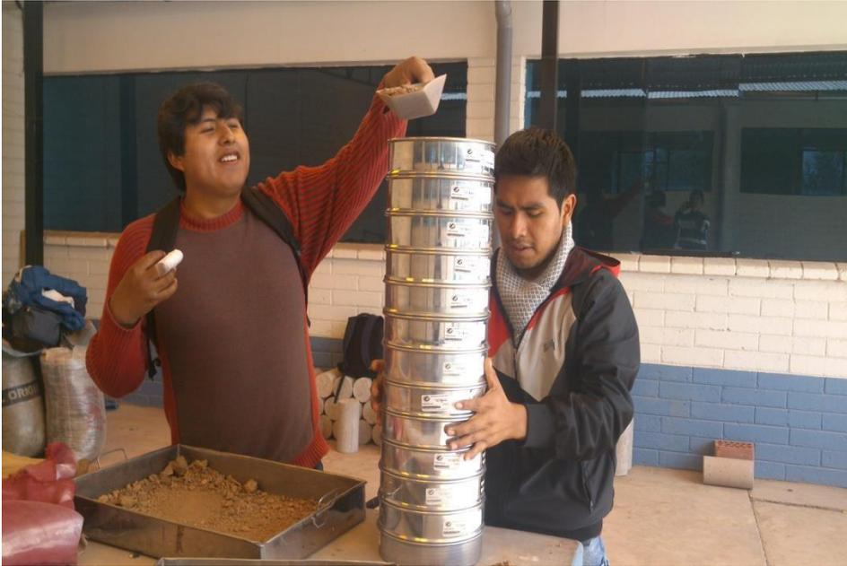
Imagen N° 13: Preparando la muestra para hacer la granulometría.
