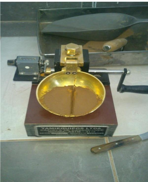
Imagen N° 20: La muestra después de realizar los golpes en el equipo. (Limite líquido).
