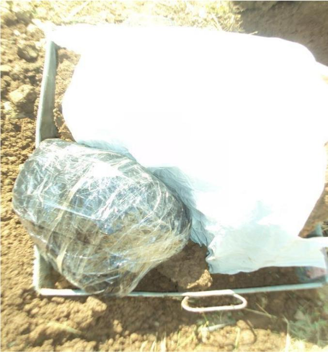
Imagen N° 11: Muestra envuelto con plástico para evitar que pierda humedad.
