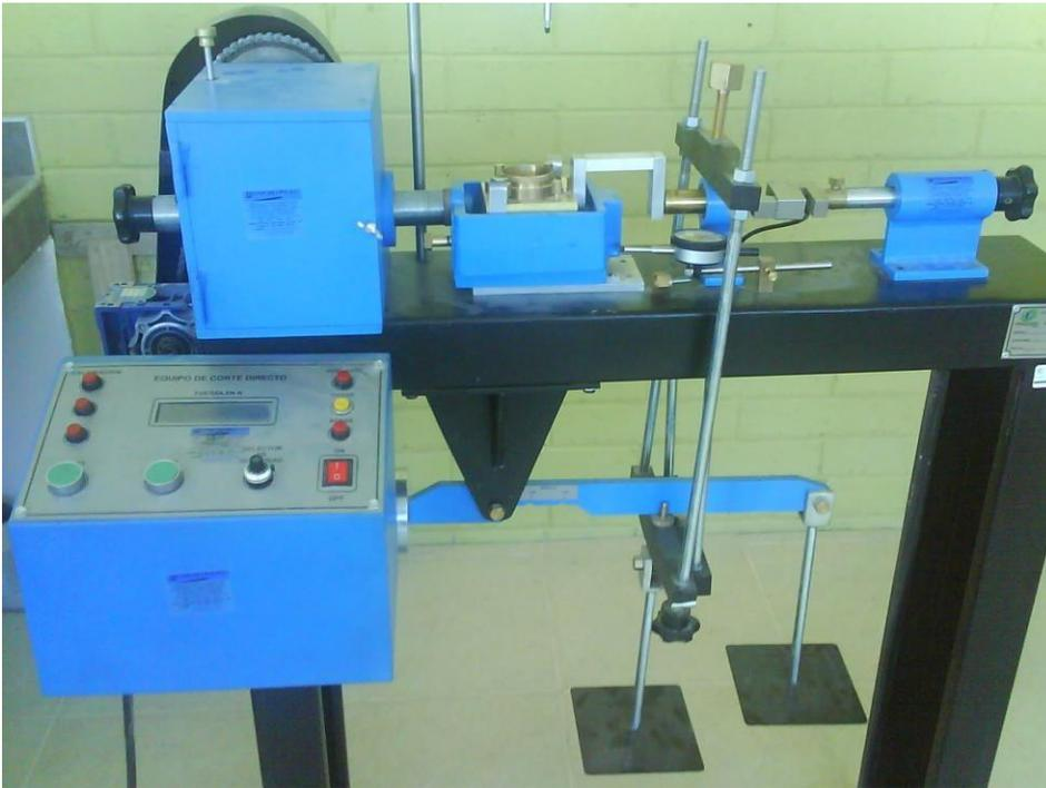
Imagen N° 23: Equipo de corte directo, para determinar la capacidad portante del suelo.
