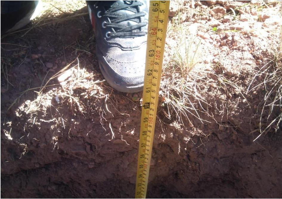
Imagen N° 09: Realizando las respectivas medidas de la calicata. Altura de 1.50 m.
