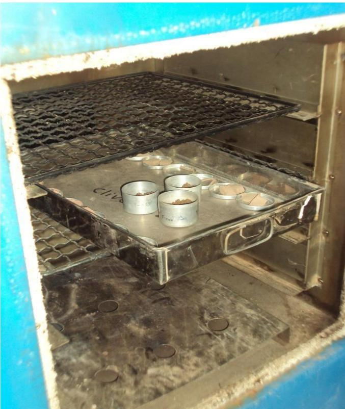
Imagen N° 12: Muestra en el horno para determinar el contenido de humedad.
