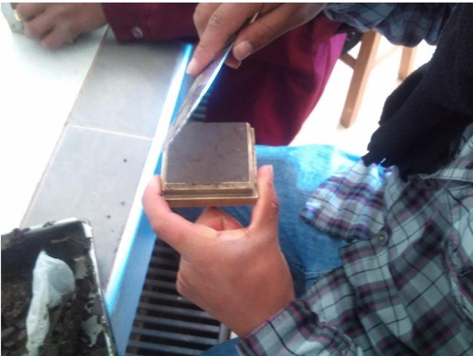
Imagen N° 26: Preparando la muestra para el ensayo, rasurando la muestra a nivel del equipo.
