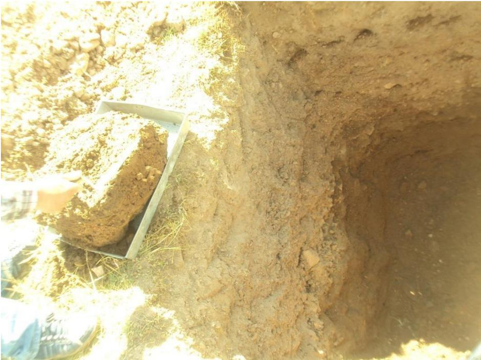
Imagen N° 10: Muestra para realizar los ensayos en laboratorio.
