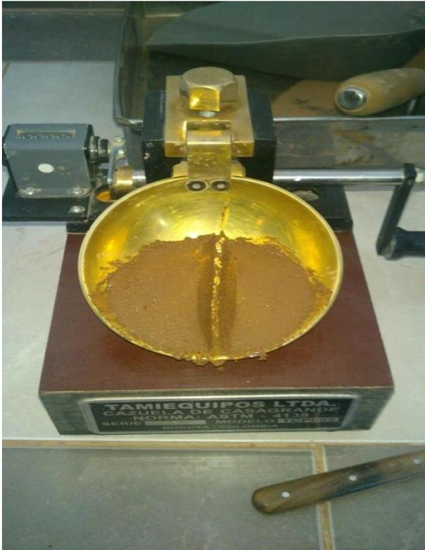
Imagen N° 19: La muestra partido con el rasurador. (Limite líquido).
