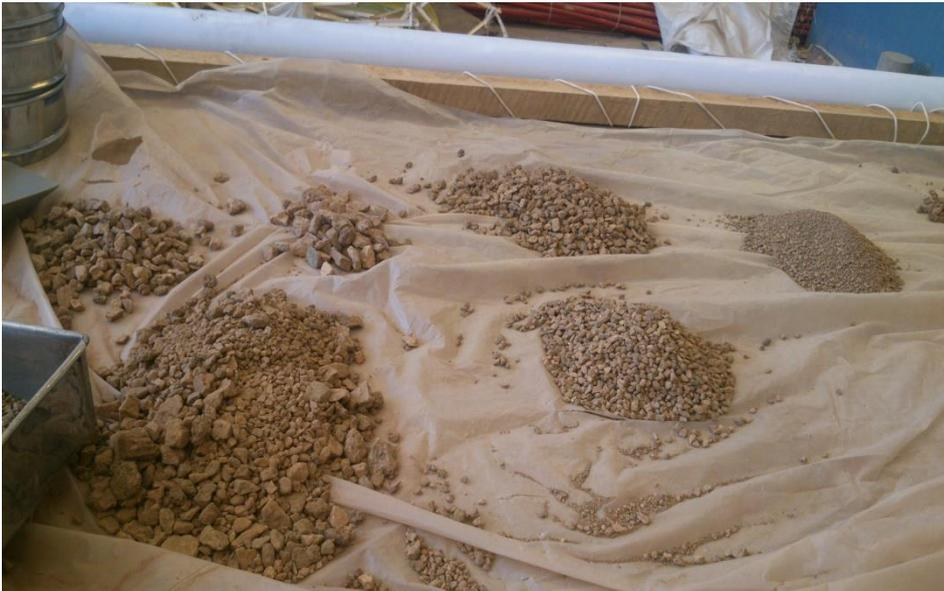
Imagen N° 14: La muestra después de la granulometría. Separado según tamaño.
