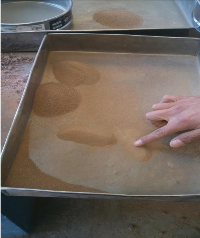
Imagen N° 15: Agregado fino listo para realizar el ensayo de Límites de Consistencia.
