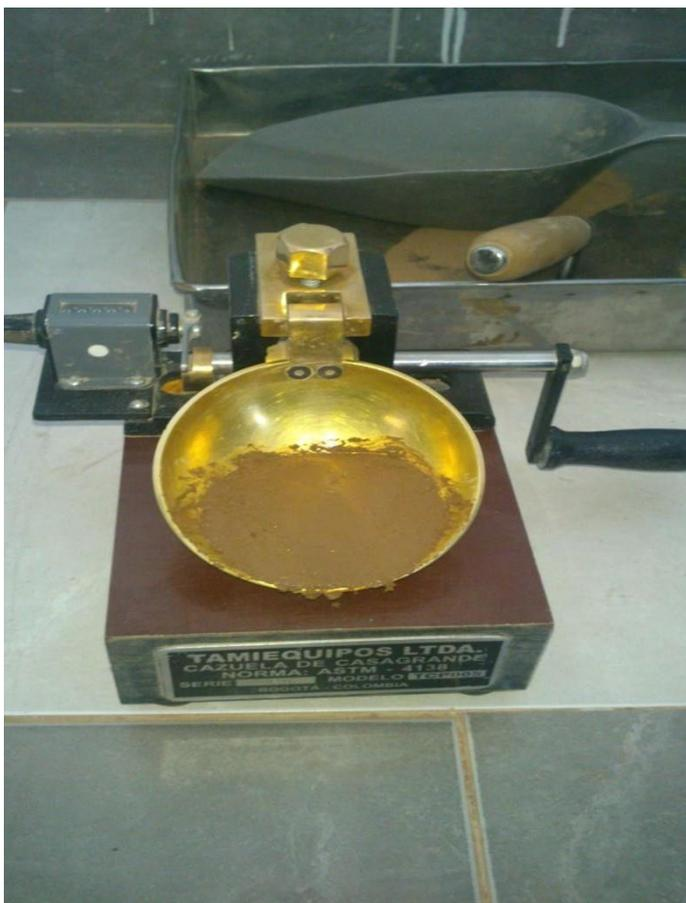
Imagen N° 18: La muestra ya lista para realizar el ensayo (Límite líquido).
