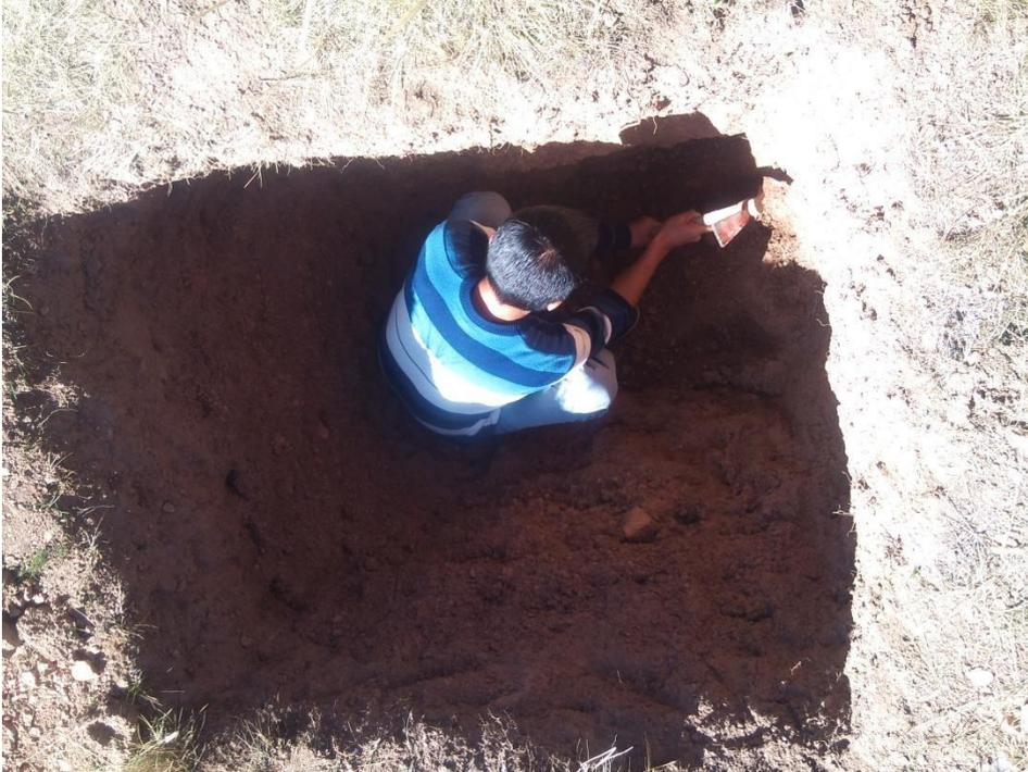
Imagen N° 07: Excavando el suelo para tener una calicata para realizar el estudio geotécnico.
