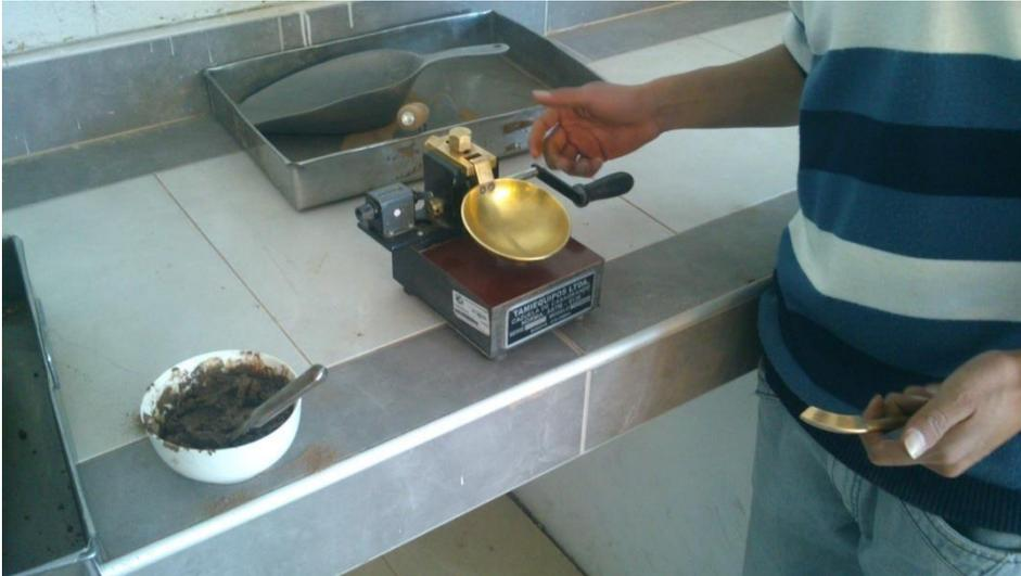
Imagen N° 17: El equipo de Casa Grande listo para el ensayo. (Limite líquido).
