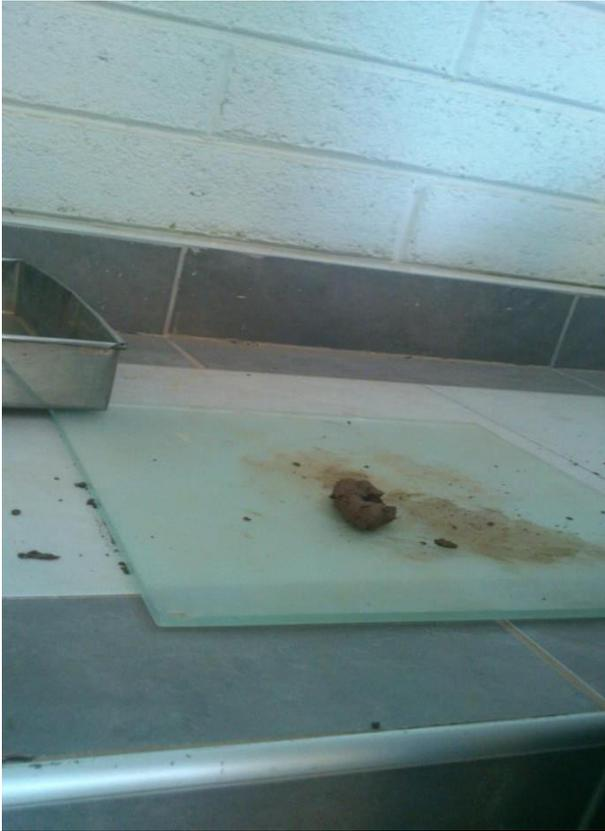
Imagen N° 21: La muestra lista para realizar el límite plástico. (Limite plástico).
