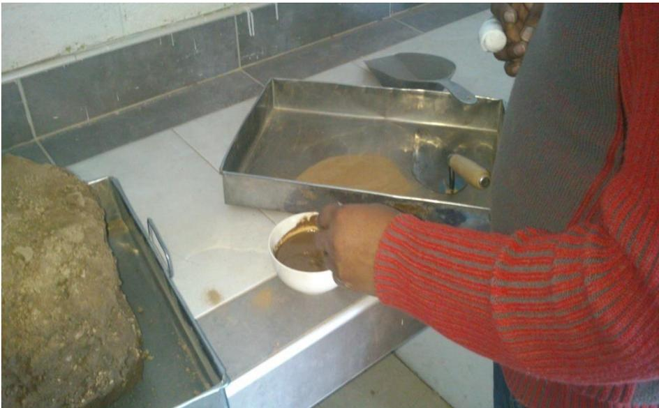
Imagen N° 16 : Preparando la muestra del ensayo para determinar el límite líquido. Fuente: Camara digital
